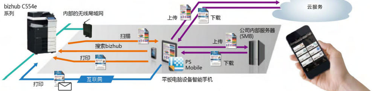
bizhub 复合机与移动设备连接示意图
